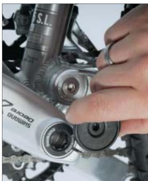
**6 REIN – RAN – UND FEST** Die Kurbelkappe sorgt dafür, dass das ganze System auch wirklich spielfrei arbeitet. Schrauben Sie daher zuerst die Kurbelkappe locker mit der Hand in die linke Kurbel. Verwenden Sie jetzt das Shimano-Originalwerkzeug TL-FC 16 (liegt dem Kurbelkit bei). Handwarm, das heißt leicht anziehen. In Zahlen: Handwarm entspricht in diesem Fall gerade einmal 0,4–0,7 Nm. Die Kurbeln wandern nun die letzten Zehntelmillimeter zueinander.
