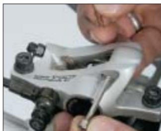
**4 SAFETY FIRST** Damit beim Entlüftungsprozedere keine Bremsflüssigkeit auf die Beläge gelangen kann, sollten Sie diese komplett demontieren. Wer Öl auf die Beläge kleckert, muss diese unbedingt ersetzen. Also raus damit. Geht fix und spart später Geld und Nerven! Sicherungsklemme mit kleiner Zange abziehen, Splint mit Inbus herausdrehen, Beläge inklusive Feder entnehmen und sauber zwischenlagern.
