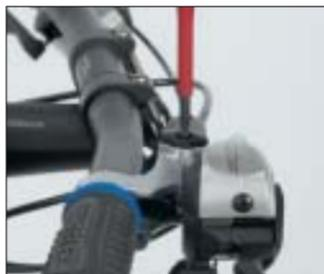
**1 KÖPFCHEN BEWEISEN** Bevor Sie mit einem kleinen Kreuzschlitzschraubendreher die beiden Schraubchen des Reservoirdeckels entfernen, sollten Sie den Bremsgriff unbedingt waagrecht ausrichten. So verhindern Sie unnötigen Verlust von Bremsflüssigkeit – die folgenden Schritte fallen deutlich leichter.
