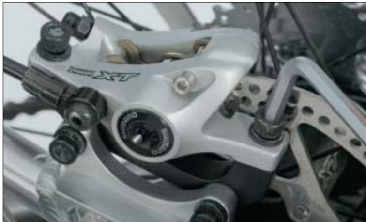
**4 BEFESTIGUNG** Wenn das Hinterrad fest fixiert im Hinterbau hängt, können Sie das Bike zur weiteren Montage wieder an den Montageständer hängen. Während Sie nun kräftig den Bremshebel ziehen (die Kolben richten den Sattel nun zur Scheibe aus), ziehen Sie die beiden Schrauben des Bremsstatts mit circa 8 Nm an. Wenn sich der Sattel beim Festziehen der oberen Schraube nach innen weg dreht, müssen Sie vor dem Fixieren zwischen Schraubenkopf und Sattel ein wenig Fett aufbringen.
