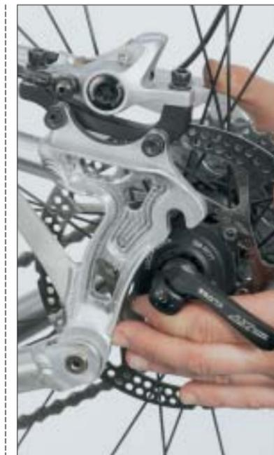
**2 LAUFRAD REIN** Da Sie in Step 1 die Sattelschrauben geöffnet haben, können Sie nun das Laufrad problemlos samt vormontierter Scheibe in den Hinterbau setzen und die Scheibe zwischen die Beläge in den frei verschiebbaren Sattel führen.
