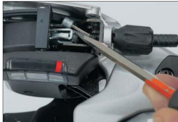
**3 SESAM ÖFFNE DICH!** Der Deckel lässt sich jetzt leicht hochklappen. Fädeln Sie den Zug (in Richtung von der Ganganzeige weg) mit einem kleinen Schraubendreher locker aus der Führung. Der Nippel löst sich extrem einfach – also keine Gewalt bitte.
