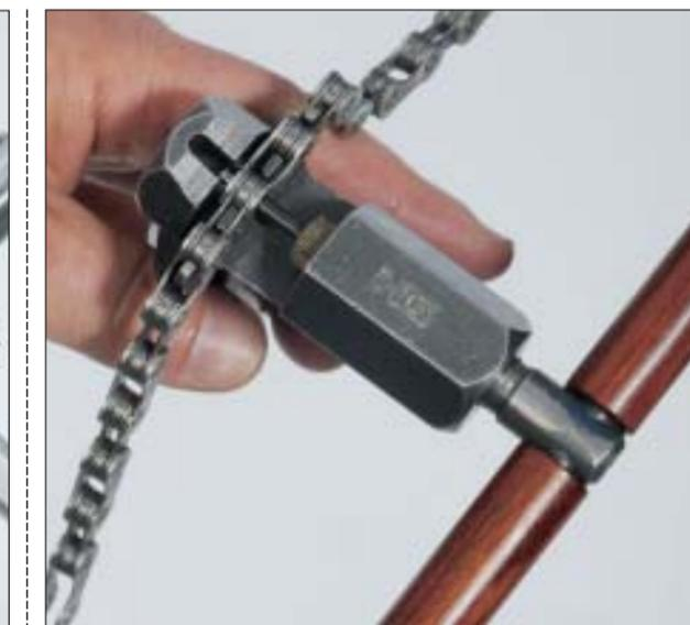
**3 ABLÄNGEN** Wer regelmäßig Ketten erneuert, sollte sich einen hochwertigen Nieter leisten. Für Hobbyschrauber tut's auch die Minitool-Variante. Die Kette muss sauber in der Führung liegen, der Nieter exakt mit dem Bolzen fluchten.
