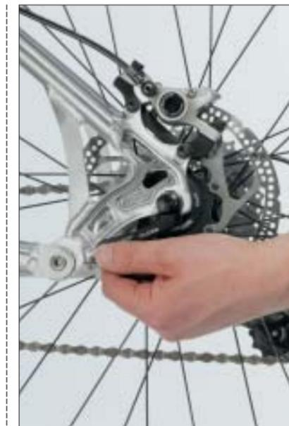
**3 SPANNUNG ERZEUGEN** Bevor Sie den Schnellspanner schließen, müssen Sie Ihr Bike auf den Boden setzen und das Hinterrad gleichmäßig in die Ausfallenden drücken. Nur so gewährleisten Sie, dass Ihr Hinterrad exakt im Hinterbau sitzt und dass das nachfolgende Ausrichten des Bremsstells von Erfolg gekrönt ist.
