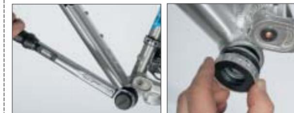
**3 LINKS** Alles anders als rechts und doch ähnlich: Fett auf Gewinde, nur einen Spacer verwenden und Lagerschale im Uhrzeigersinn „richtig“ herum eindrehen. Mit Drehmomentschlüssel auf 35–50 Nm anziehen.
