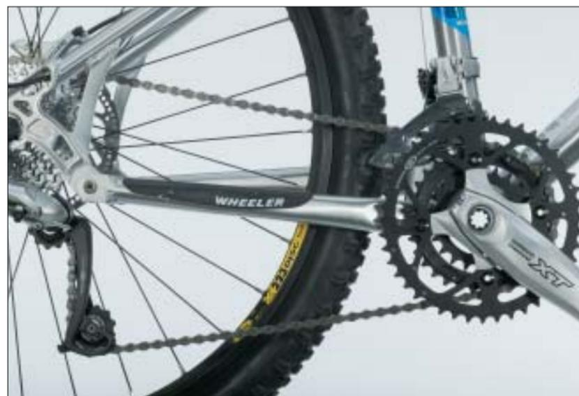
**2 KETTENLÄNGE, DIE ZWEITE** Ein wenig umständlicher als Version 1, dafür exakter. Kette durchs Schaltwerk fädeln, vorne übers mittlere Kettenblatt und hinten übers größte Ritzel legen. Kontrolle: Der Käfig des Schaltwerks muss jetzt exakt senkrecht stehen. Überschüssige Glieder mit dem Nieter entfernen.
