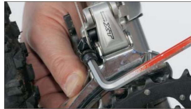
**7 BEKLEMMEND** Der richtige Moment, um die Position des Umwerfers zu checken. Sitzen die Führungsbleche exakt parallel zu den Kettenblättern? Ja? Perfekt, dann führen Sie jetzt den Zug durch die vorgesehene Kerbe unter der Klemmschraube, spannen ihn kräftig mit der Hand – und klemmen ihn.
