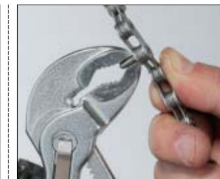
**5 ABRUCH** Die Kette fest nahe dem Pin fassen und mit einer kräftigen Zange den Pin parallel zur Kette abbrechen. Vorsicht: nicht im 90°-Winkel!
