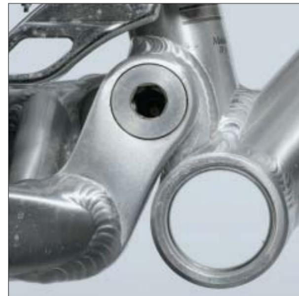
**1 PLAN FRÄSEN** Wer sich keinen Ärger für die Zukunft programmieren möchte, bringt nach der Demontage des alten Innenlagers seinen Rahmen zum Händler, um das Kurbelgehäuse kontrollieren zu lassen. Lack auf dem Innenlagergehäuse ist ein klares Indiz für mangelhafte Rahmenvorbereitung und dafür, dass die Flanken des Innenlagergehäuses nicht exakt parallel zueinander fluchten. Hier muss unbedingt nachgefräst werden. Wer seine Kurbel dennoch verspannt montiert, riskiert ein frühes Aus der Lager.
