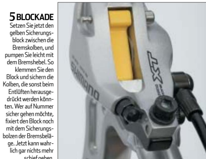
**5 BLOCKADE** Setzen Sie jetzt den gelben Sicherungsblock zwischen die Bremskolben, und pumpen Sie leicht mit dem Bremshebel. So klemmen Sie den Block und sichern die Kolben, die sonst beim Entlüften herausgedrückt werden könnten. Wer auf Nummer sicher gehen möchte, fixiert den Block noch mit dem Sicherungsbolzen der Bremsbeläge. Jetzt kann wahrlich gar nichts mehr schief gehen.
