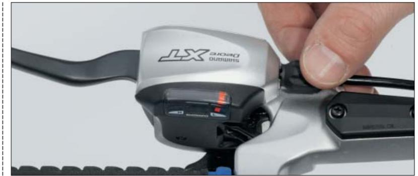
**8 SPANNUNGSMOMENT** Wuchtet der Umwerfer die Kette schon problemlos von Blatt zu Blatt? Na prima! Wenn nicht, müssen Sie die Zugspannung noch feinjustieren. Wandert die Kette nicht aufs nächstgrößere Kettenblatt – Zugspannung erhöhen (Schraube herausdrehen). Schaltet der Umwerfer nicht aufs nächstkleinere Kettenblatt – Zugspannung reduzieren (Schraube hineindreihen).
