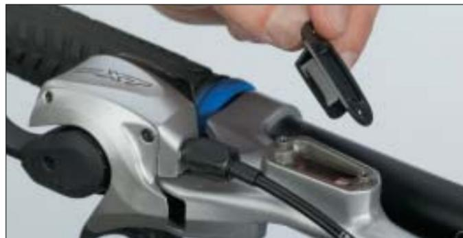
**3 WEITER GEHT'S** Nur keine Scheu beim Lösen der Membran: Auf Gummihandschuhe können Sie dabei getrost verzichten, denn das von Shimano verwendete Mineralöl ist nicht toxisch wie herkömmliche Bremsflüssigkeit (aber trotzdem umweltbelastend – also gesondert entsorgen). Auch scharfkantiges Werkzeug gehört hier nicht her: Die Membran lässt sich leicht mit dem Fingernagel vom Rand des Reservoirs lösen und abheben.
