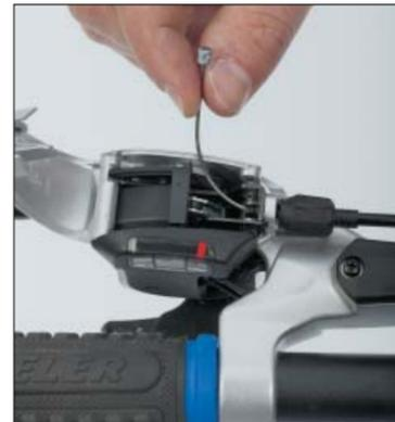
**4 AUSGEDIENT** Der Deckel ist auf, der Nippel ist lose: Ziehen Sie nun den alten Zug aus der Außenhülle heraus. Völlig trocken? Dann sollten Sie auch die Außenzüge wechseln.
