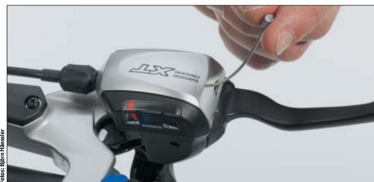
**3 NEULING** Entfernen Sie den alten Zug. Der neue Zug lässt sich nun problemlos durch das Gehäuse und den Außenzug schieben. Klappt nicht? Dann steht der Schaltmechanismus nicht im kleinsten Gang, sprich größtem Ritzel. Hebel mehrfach nach oben schalten! Zug einschieben, Kreuzschlitzschraube wieder einsetzen – Zug wie zuvor beschrieben am Schaltwerk mit Ser-Inbus klemmen.
