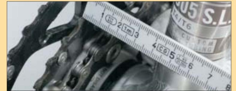
■ **Kettenlinie** Messen Sie mit einem Meterstab von Mitte Sitzrohr bis zum mittleren Kettenblatt. Voilà. Bei Shimanos Hollowtech-Kurbeln sollten Sie 50 mm ablesen können!
