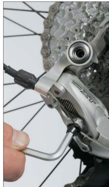
**1 SPANNUNGSLÖS** Step one: Entlasten Sie den Schaltzug, indem Sie alle Gänge bis aufs große Ritzel runterschalten (zur Erinnerung: Sie arbeiten an einem Inverse-Schaltwerk!). Lösen Sie jetzt mit einem Ser-Inbus die Klemmschraube des Zugs am Schaltwerk.
