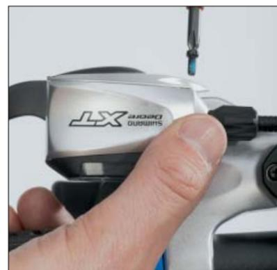
**6 SCHLUSSSACHE** Drehen Sie nun die Spannschraube im Uhrzeigersinn bis zum Anschlag hinein und lösen Sie sie dann wieder um eine Umdrehung. Dies schafft nötigen Spielraum für die spätere Justage der Zugspannung. Jetzt den Deckel zuklappen und mit der kleinen Kreuzschlitzschraube (finden Sie auf dem sauberen Lappen auf der Werkbank) verschließen. Den empfindlichen Winzling bitte ohne Gewalt fixieren!
