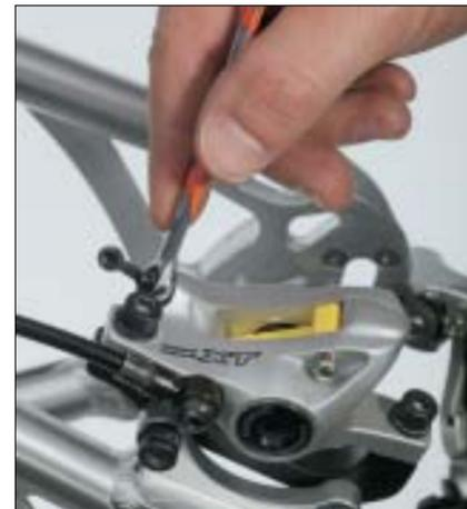
**6 RING-SCHLÜSSEL** Staubkappe öffnen. Setzen Sie nun einen 6er-Ringschlüssel auf den Entlüftungsnippel. Ein Maulschlüssel tut's zwar auch, der Ringschlüssel hält sich aber während des Entlüftens selbstständig auf dem Nippel, auch wenn Sie ihn zeitweise nicht festhalten können. Das vereinfacht die folgenden Arbeitsschritte enorm.
