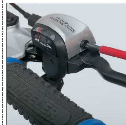
**2 SCHRAUBE LOCKER** Anders als am linken Schalter, müssen Sie hier nicht das Gehäuse öffnen. Drehen Sie nur mit einem Kreuzschlitzschraubendreher die Schraube seitlich am Gehäuse heraus.
