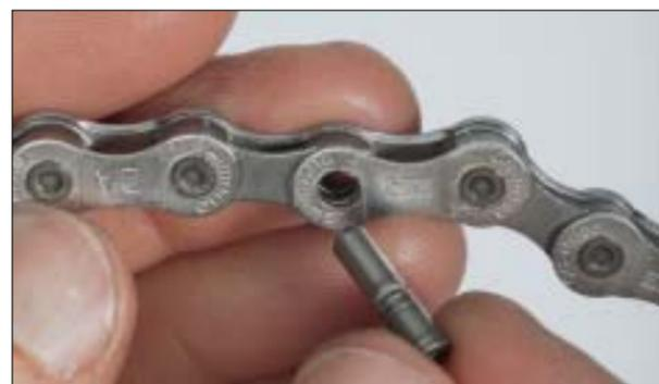
**4 PIN** Todsünde: Nie den alten, herausgedrückten Pin wieder hineinpressen. Immer neuen Pin verwenden. Wenn Sie den Pin einpressen, achten Sie darauf, dass er vorne wie hinten exakt gleich weit aus der Kette herausragt.
