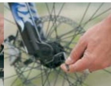
**6 STECKACHSE AUSRICHTEN** Vorsicht beim Festziehen von Steckachsen: Immer erst eine Seite einschrauben und klemmen, dann mehrfach Einfedern, bevor Sie die andere Seite klemmen. Tun Sie das nicht, besteht die Gefahr, das Casting zu verspannen, worauf die Standrohre nicht mehr sauber gleiten können. Die Federung wird dann unsensibel.
