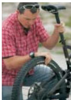
**2 HINTERBAU CHECKEN** Die Hinterbaulager müssen frei von seitlichem Spiel sensibel laufen. Ein loser Hinterbau fährt kippelig, schlechte Lager wirken wie überdämpft. Auch die Hinterradnabe muss spielfrei sein. Lose? Nachstellen.
