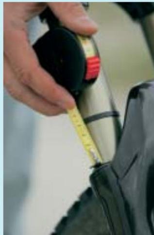
**9 NEGATIV-FEDERWEG AUSMESSEN** Messen sie jetzt den Abstand zwischen der Unterkante des etwas nach oben verschobenen Kabelbinders und der Staubschutzkappe. Et voila: der genutzte Negativ-Federweg. Vergleichen Sie ihn mit dem in Punkt 6 errechneten. Zu viel? Dann müssen sie weitere Luft einpumpen und die Messung wiederholen, bis das Maß stimmt. Zu wenig? Luft ablassen.
