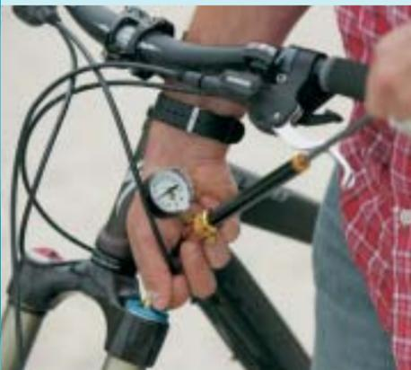
**7 LUFTKAMMER BEFÜLLEN** Pumpen Sie die Positiv-Luftkammer auf. Oft helfen Herstellerangaben zur Orientierung (Ami-Gabeln: soviel PSI wie Teile des Fahrergewichts in amerikanischen Pfund; 1 lb = 0,454 kg). Gabeln mit Positiv- und Negativ-Kammer beidseitig befüllen! Gabeln mit Luft-Federwegverstellung (Fox Talas, Rock Shox U-Turn Air) zum Befüllen ganz lang drehen, Doppelkammersysteme (Manitou IT) während des Befüllens entlüften und Druck bei geöffnetem Zwischenventil (Hebel gedrückt!) checken.
