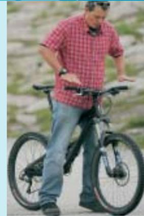
**13 DRUCKVERSUCH, DIE ZWEITE** Beim Entlasten und Ausfedern sollten die Hände völlig weg vom Lenker, das Ausfedern also völlig unbehindert sein. Beobachten Sie, ob der Vorderreifen beim Ausfedern kurz abhebt? Die Zugstufe ist noch etwas zu weich. Schließen Sie sie weiter, bis das Vorderrad beim Entlasten gerade so nicht abhebt – nun sollte die Gabel für alle Unwägbarkeiten des Trails gerüstet sein: Klamotten an, probetampeln und Löcher ausfedern kann. Auf dem Trail fein abstimmen.
