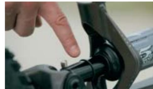
**1 FEDERWEGS-INDIKATOR FINDEN ODER ANBRINGEN** Die meisten Federbeine verfügen bereits ab Werk über einen Gummiring auf der Kolbenstange, der beim Federn vorgeschoben wird und in der Position des maximal genutzten Federweges verbleibt. Ihr Federbein hat keinen? Ziehen sie wie an der Gabel einen Kabelbinder um die Kolbenstange, die sie vorher von Schmutz befreit haben, schneiden sie den Überstand ab. Funktioniert auch am Stahlfederbein (innen an der Kolbenstange).
