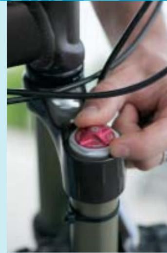
**11 ZUGSTUFE EINSTELLEN** An der Fox sitzt der zuständige Stellknopf rechts oben, an vielen anderen Gabeln rechts unten. Vergleichen Sie zum Lernen im Druckversuch, wie die Gabel mit ganz offener (gegen den Uhrzeigersinn bei Sicht auf den Drehknopf) und ganz geschlossener (mit dem Uhrzeigersinn) Zugstufe ausfedert. Drehen Sie die Zugstufe für die folgende Einstellung zunächst ganz auf.
