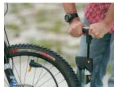
**4 REIFENLUFT-DRUCK** Nicht nur beim Hardtail übernehmen die Reifen einen wichtigen Teil der Federung, puffern harte Stöße ab, verbinden Bike und Boden, gewährleisten Grip, Spur- und Querstabilität – solange der Luftdruck stimmt. Zu wenig, und die Dinger gautschen, machen das Bike unstabil. Mindestens 2,0 bar sollten schon in den Pellen stecken, bei grobschlächtigen Fahrern auch mehr, um Durchschläge zu vermeiden. Und: Nur so macht weiteres Setup Sinn.
