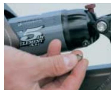
**5 VENTIL-SCHUTZKAPPE** Viele Biker lassen die unscheinbaren Kappchen einfach von den Schraderventilen an den Federelementen weg. „Verlegt, zu lästig, gehört da eine Kappe hin?“ kommt dann meist. Immer gleiche Antwort: Jawoll, da gehört eine Kappe hin, denn die übernimmt beim Schraderventil einen wichtigen Teil der Dichtung. Wer allerdings dauernd nachpumpen will, kann die Kappe ruhig weglassen ...
