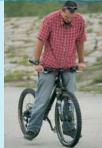
**10 DURCHSCHLAGSCHECK** Der folgende Test simuliert nicht gerade die Gewalt eines Noseländers, zeigt aber ganz gut, ob die gewählte Federrate passt. Stützen sie sich mit Schwung und aller Kraft auf den Lenker, um die Gabel schlagartig mit ganzem Körpergewicht zu komprimieren. Schlägt auf Block? Nachpumpen.
