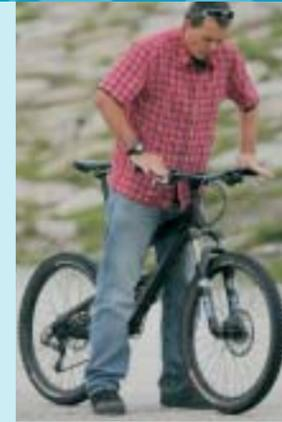
**12 DRUCKVERSUCH, DIE ERSTE** Drücken sie den Lenker kräftig und ruckweise herunter, federn die Gabel also stark ein. Lassen sie ihn unmittelbar von den Händen nahezu unbelastet zurückschnappen, die Gabel also ausfedern. Beobachten Sie, wie schnell die Gabel dabei ausfedert. Ist das Ausfedern deutlich langsamer als das Einfedern, müssen Sie die Zugstufe weiter öffnen, damit sich die Gabel auf dem Trail nicht festtrampelt und Löcher ausfedern kann.
